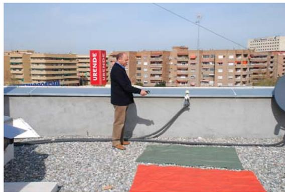
**Figura 6**—Determinación de la temperatura en la cara expuesta al Sol..
