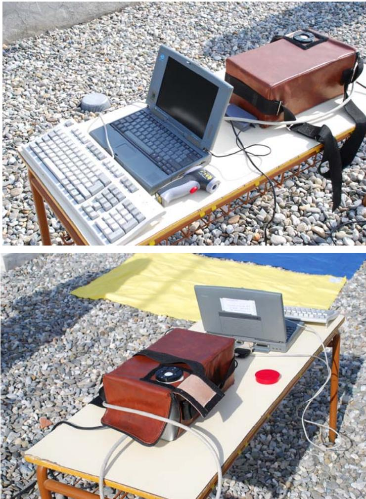
**Figura 4**—Espectrorradiómetro LICOR LI1800 en el lugar de las medias.
