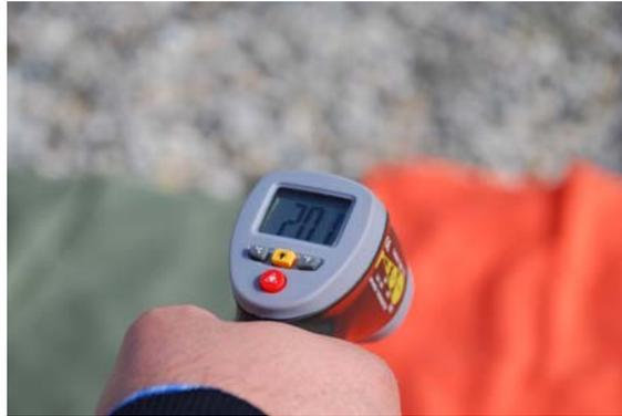
**Figura 3**—Termómetro de infrarrojos para la determinación de la temperatura de las muestras de tejido.
