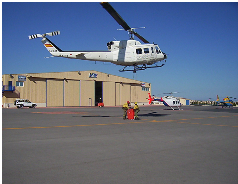
Figura 11 — Posición idónea del helibalde.
