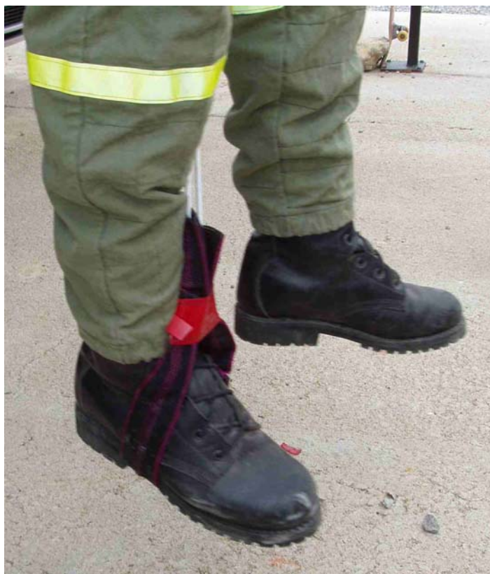
Figura 4 — Pedal integrado, detalle de cinta ajustable.
