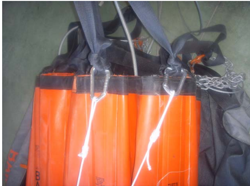
Figura 10 — Tercer paso, colocación de los mosquetones en las cintas del bambi.
